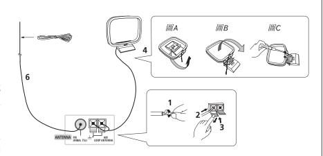
將FM線型天線裝設到FM UNBAL 75Ω天線端子上。 爲得到最佳的收聽效果,請將FM天線完全展開固定於牆上或門框上。
